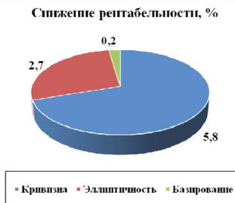
Рис. 6. Снижение рентабельности производства пиломатериалов при средних значениях: кривизны – 0,25 %, эллиптичности – 6 мм; базирования \pm 10 мм
