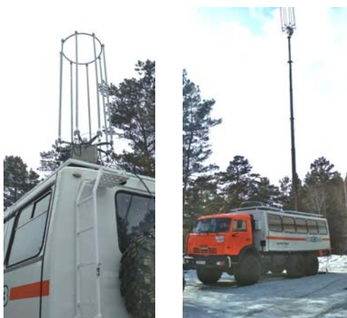
Рис. 7. Антенна АПКУ в нижнем положении мачты, видна площадка доступа и лестница (фото слева), АПКУ в развернутом положении, установлены тросовые растяжки (фото справа)
