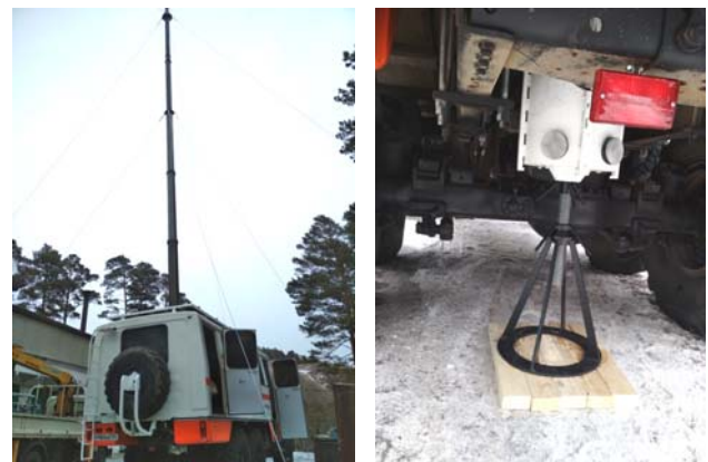
Рис. 6. Телескопическая мачта АПКУ (фото слева) и винтовой упор блокирования работы подвески автомобиля-базы (фото справа)
