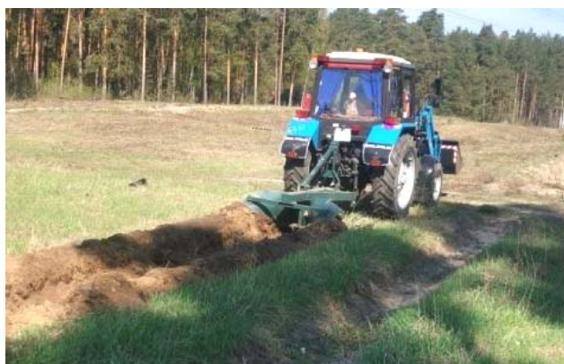
Рис. 1. Трактор МТЗ-82 с плугом ПКЛ-70 (опахивание границ лесосеки мин-полосой)
