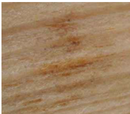
Рис. 4. Наличие пятен экстрактивных веществ на пласти высушенной лиственничной доски
