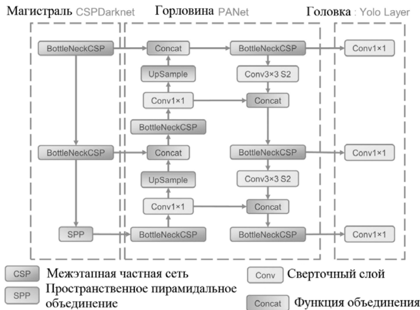
Рис. 19. Сетевая архитектура YOLOv5, включающая три блока:
