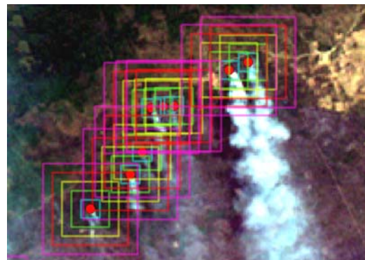
Рис. 11. Ручные метки возгораний (красные точки) и ограничивающие рамки размером от 10 до 50 пикселей [42]
