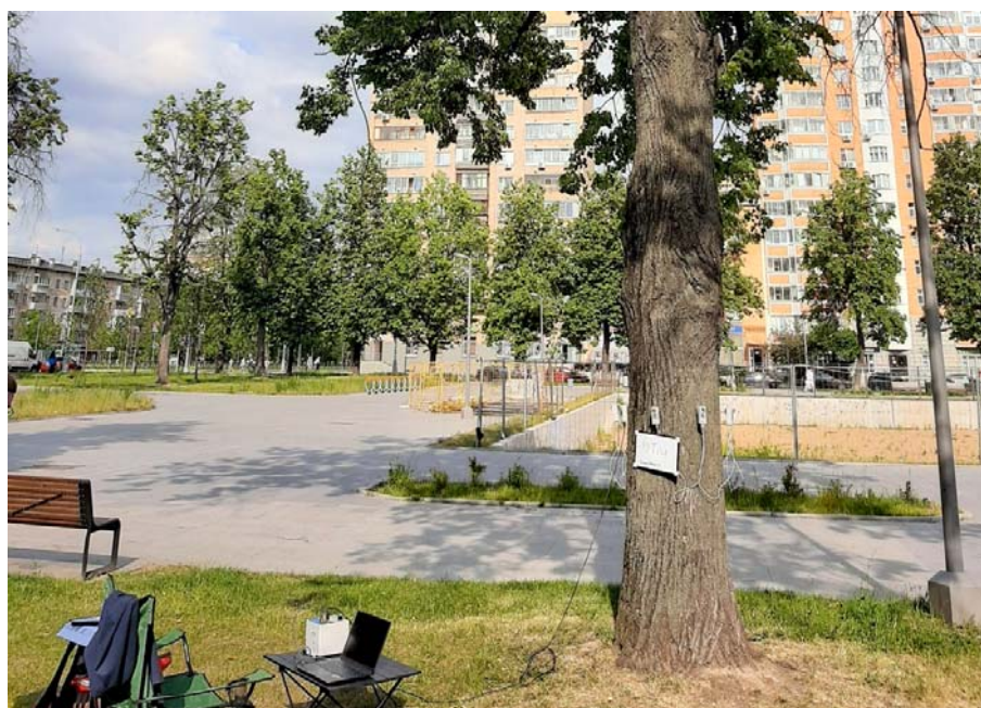
Рис. 5. Arbotom ABT06-S – трёхмерный томограф для анализа состояния древесины, Rinntech замеры от (06.06.2025)
