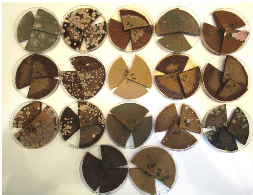
Рис. 1. Образцы композитов после 84 суток эксперимента
