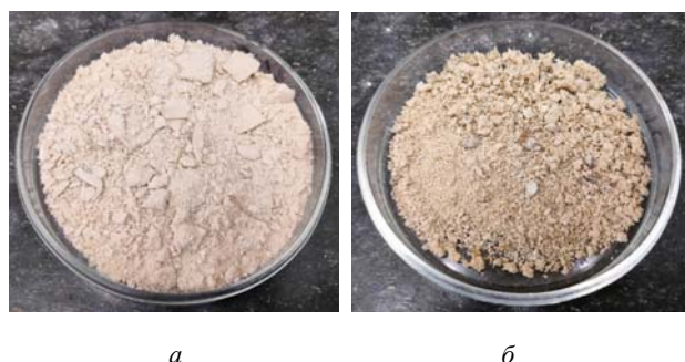
Рис. 4. Внешний вид (а) триацетат целлюлозы; (б) диацетат целлюлозы
