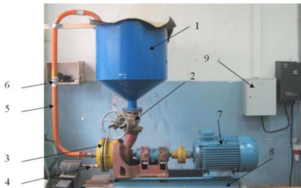
Рис. 1. Общий вид экспериментальной установки: 1 – бак; 2 – запорная арматура (завдвижка); 3 – корпус рабочей камеры установки; 4 – сливной шаровой кран; 5 – труба циркуляционная; 6 – шаровой кран; 7 – электродвигатель; 8 – рама; 9 – щит управления
