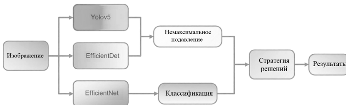
Рис. 22. Структура предлагаемой модели.
