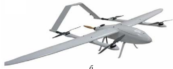
Рис. 1. Типы БАС, способные поддерживать аэрофото-съемку в самолетном режиме: а – самолетный; б – гибридный (VTOL)
