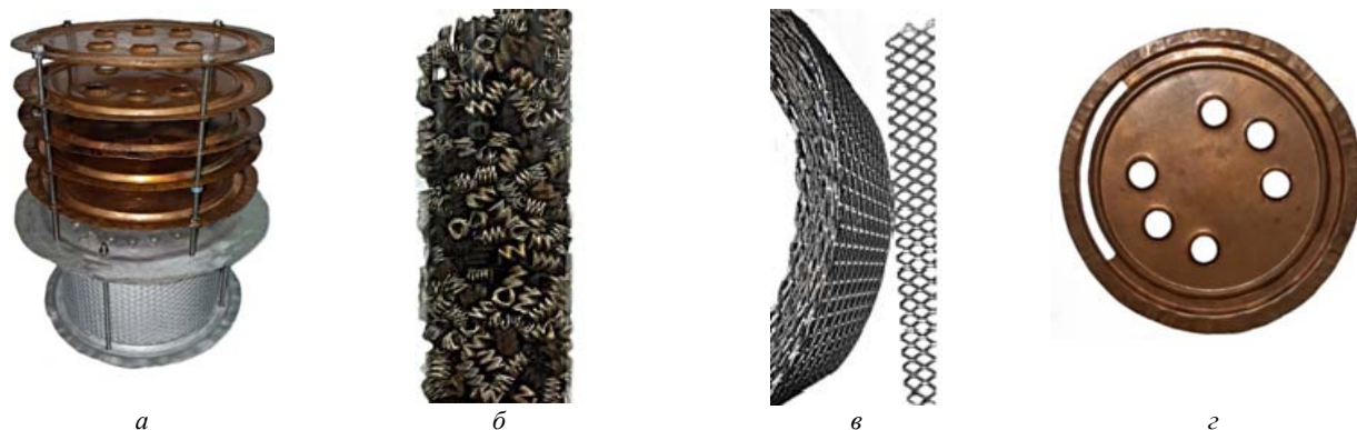
Рис. 1. Общий вид контактного устройства (а), насадки (б, в), пластины (г)
