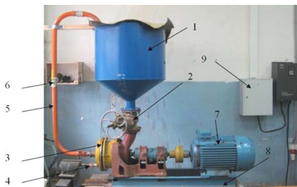
Рис. 1. Общий вид экспериментальной установки: 1 – бак; 2 – запорная арматура (задвижка); 3 – корпус рабочей камеры установки; 4 – сливной шаровый кран; 5 – труба циркуляционная; 6 – шаровый кран; 7 – электродвигатель; 8 – рама; 9 – щит управления
