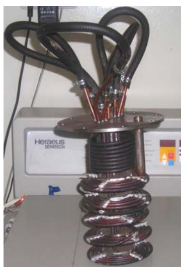
Рис. 3. Конструкция дефлегматора установленного в колонне опытного производства по получению биополимера:
