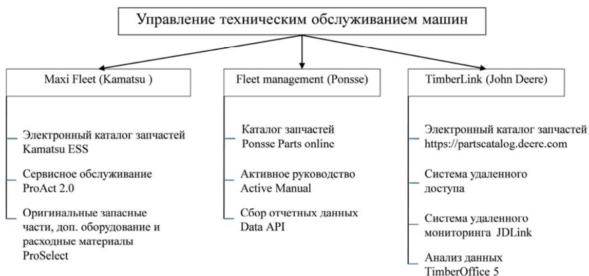
Рис. 3. Программное обеспечение для управления техническим обслуживанием техники ведущими мировыми производителями лесозаготовительной техники
