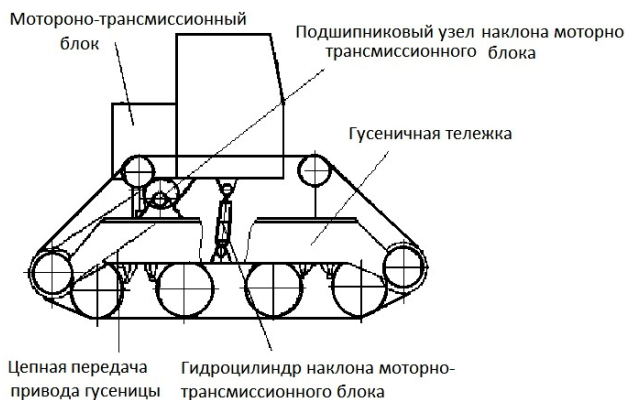
Рис. 1. Схема двухгусеничной горной машины
