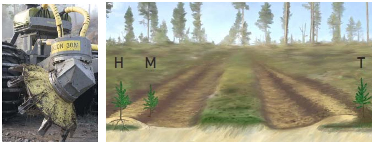
Рис. 1. Фрезерный рабочий орган установки Bracke T26 и результат формовки посадочных мест:
