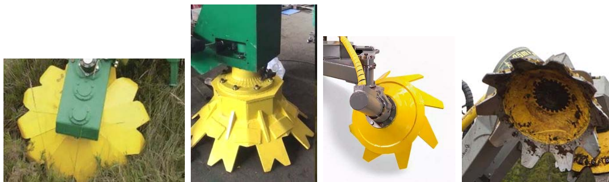
Рис. 4. Разновидности рабочих ножей-лопаток, серийно выпускаемые промышленностью:
