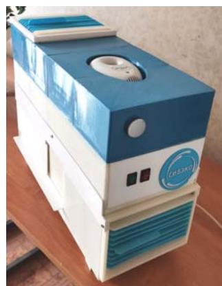
Рис. 2. Лабораторная установка «Генератор ионов»
